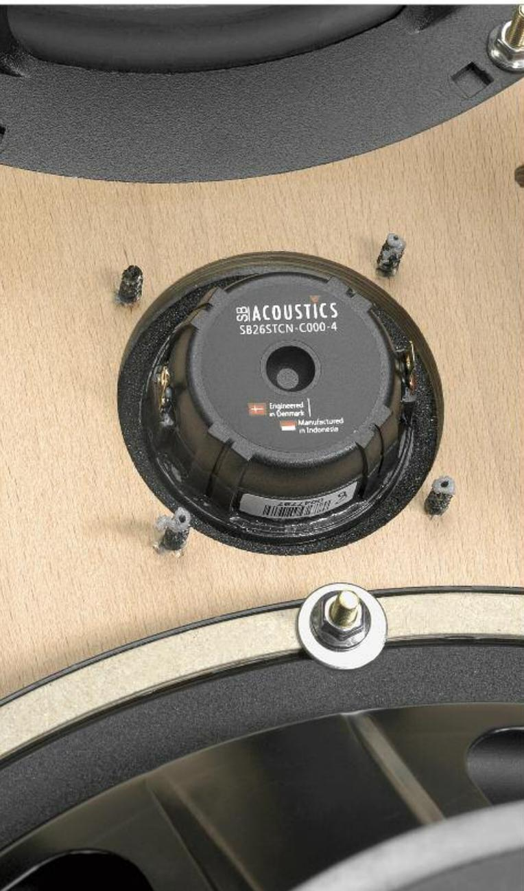
Oben links: Der renommierte norwegische Hersteller Seas beliefert Graham mit einem 8-Zoll-Mitteltöner mit Polypropylen-Membran, einem Korb aus Aluminiumguss und Keramikmagnet – selbstverständlich nach Spezifikationen der britischen Lautsprecherhermanufaktur
