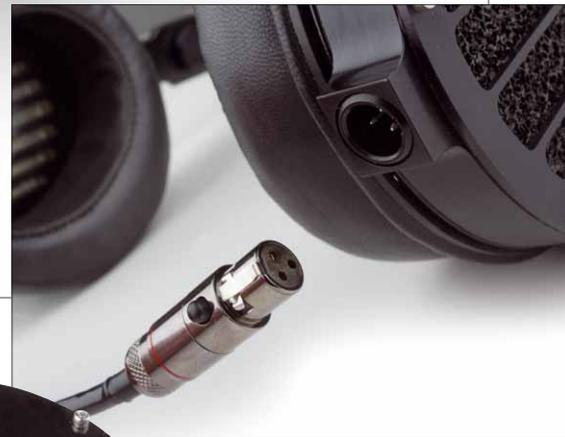
einem Mini-XLR-Stecker zum Anschluss an den Kopfhörer ausgestattet, auf der anderen Seite sind große XLR-Stecker montiert. Zum Anschluss an übliche Kopfhörerverstärker liegen Adapter auf einen 6,3-mm-Klinkenstecker sowie ein 4-Pol-XLR-Stecker für Kopfhörerverstärker mit symmetrischem Ausgang bei. In einer Holzkiste befindet sich dann eine sehr edle Ledertasche, in der letztendlich der Kopfhörer steckt. Ok, auf Show haben sich die Amerikaner ja schon immer verstanden.
